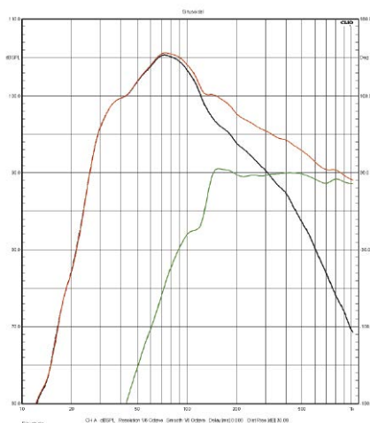
Rys. 3. Charakterystyki sekcji niskotonowej i średniotonowej.
